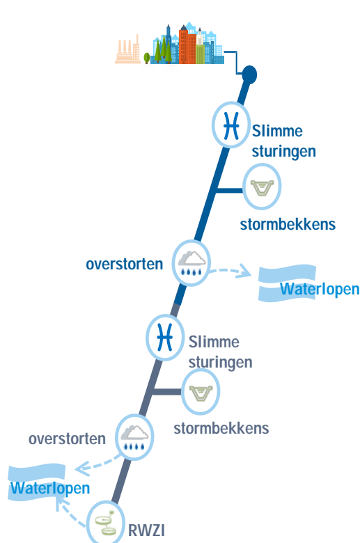
Figuur 2 - Componenten afvalwatersysteem
