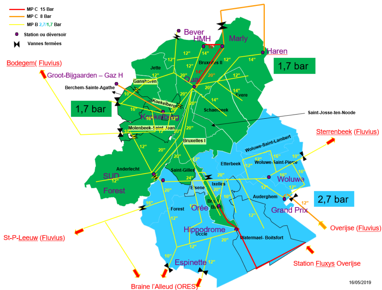
Figuur 5.3 b – Schematische voorstelling van het MD-net na integratie van de GOS'en Iverlek-Dilbeek en Kaai
