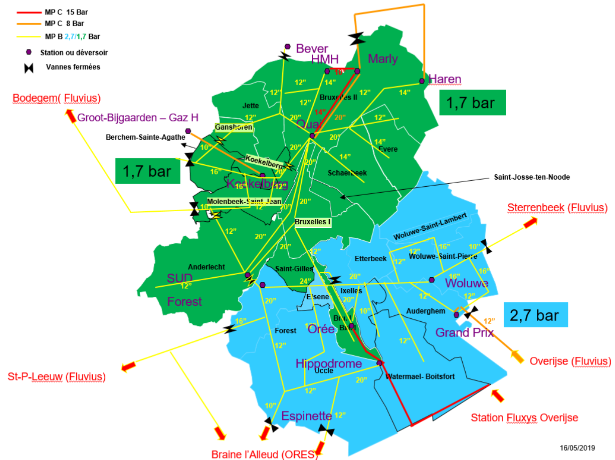
Figure 5.3 b – Représentation schématique du réseau MP après intégration des SRA Iverlek et Quai
